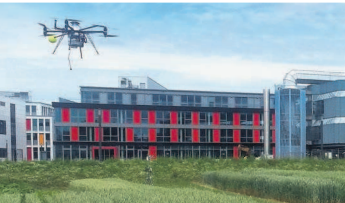
Sie nimmt Pflanzenbestände aus unterschiedlichen Höhen auf und liefert ortsgenaue Informationen über die Vitalität der Kulturen.
